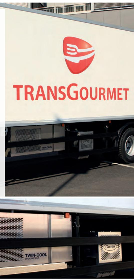
Der geringere Energieverbrauch elektrischer Aggregate wirkt sich spürbar auf den Treibstoffverbrauch aus: Bei uns so ausgestattete LKW verbrauchen 9,5 Prozent – das entspricht im Schnitt 2,9 Liter – weniger Treibstoff pro 100 Kilometer. Zusammen mit der Umstellung von 18-Tonner-LKW auf 16-Tonner-LKW sparen wir weiteren Treibstoff und Emissionen ein (vgl. vorheriger Abschnitt).
